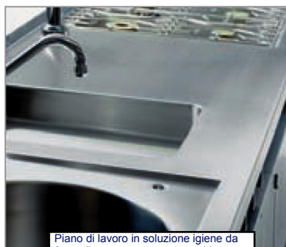
Piano di lavoro in soluzione igiene da 3mm di spessore con apparecchiature saldate senza fuga alcuna
